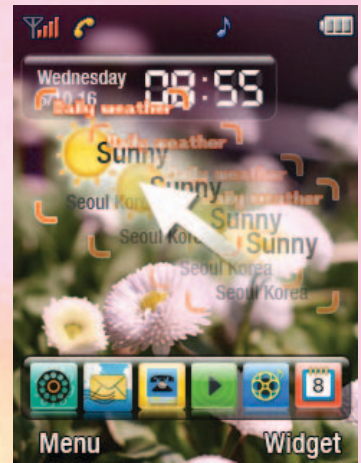
Prizm 3.0에서 선보인 드래깅(Dragging) 기능. 화면의 Widget을 사용자가 터치 컨트롤로 직접 위치 이동할 수 있게 한다.
